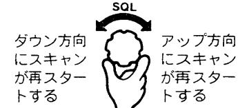
信号が途切れると約2秒後、信号が続いているときは約5秒後に再スタート(P49,52)します。また、DIALを回すと強制的に再スタートします。
