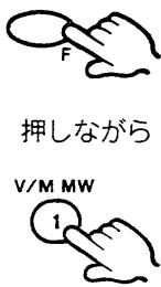
一時停止中にビープ音が“ピッピピ”と鳴るまで、Fスイッチを押しながらMWキーを押します。
