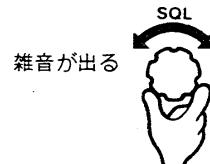
SQL(スケルチ)ツマミを時計方向に回し、Sメーターが消えるところに調整します。
