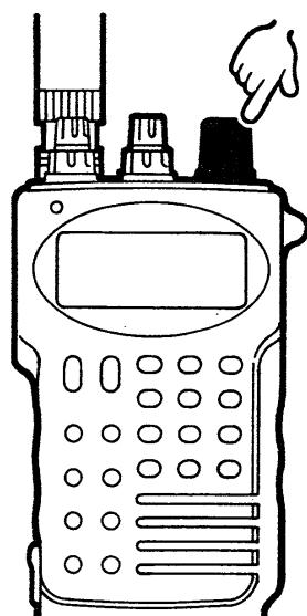
DIALを時計方向に回すと周波数がアップし、反時計方向に回すとダウンします。
