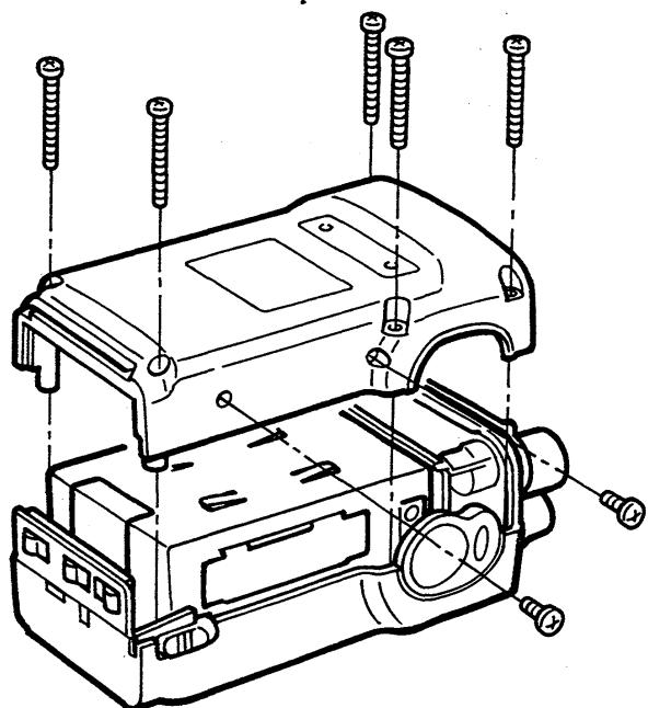
※使用するドライバーは、ネジ山がつぶれないように、ネジ山によく合ったプラスドライバーを用いてください。
