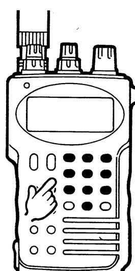
MHz桁の数字から順番に、置数キーを押します。3桁押し終えると(ビープ音が“ピー”と鳴り)入力完了です。
