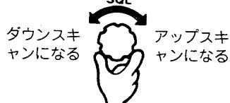
DIALを時計方向に回すとアップし、逆に回すとダウンします。
