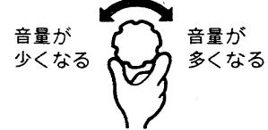
VOL(音量)ツマミを時計方向に回します。
