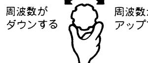
DIAL(ダイヤル)を時計方向に回すと周波数が高くなり、反時計方向に回すと低くなります。
