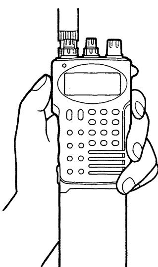
自局の電波でレピータが作動していることを確認し、通常の交信と同様に交信してください。
