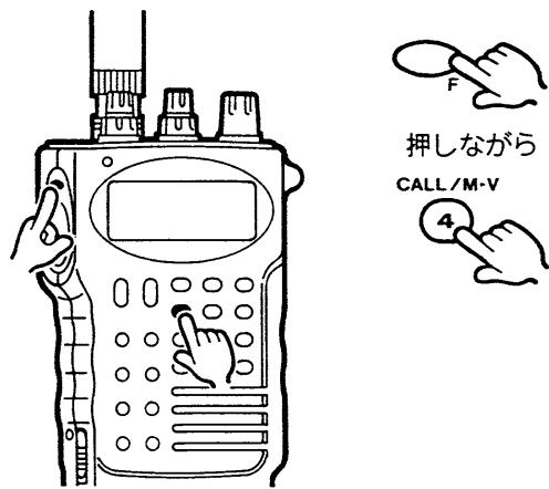
ビープ音が“ピッピピ”と鳴るまで、Fスイッチを押しながらM▶VFOキーを押します。
