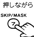
Fスイッチを押しながらMASKキーを押すと、前回設定した指定時刻が表示されます。
