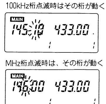
Fスイッチを押しながらDIALを回すと、あらかじめ設定しておいた実行桁が動きます。③だけを操作すると、以前に設定しておいた実行桁が動きます。このとき、実行桁は点滅しません。
