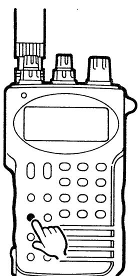
14桁以下のコードで終了するときは、DTMFキーを押すと終了します。15桁のときは自動的に終了します。
