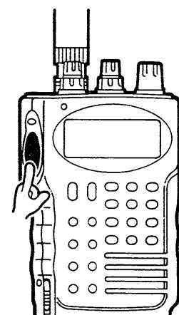
PTTスイッチを1回押すと、相手局と自局(ページャーのみ)のコードを表わすDTMF信号が送出されます。
