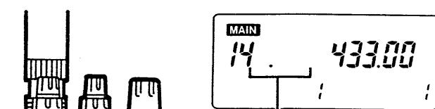
MHz以下の桁が消える
