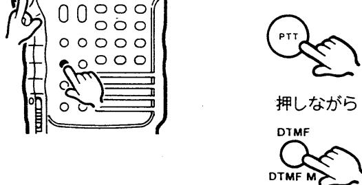
PTTスイッチを押しながらDTMFキーを押します。以上の操作とは別に、VFOモードで送信しながら1桁づつ送出することもできます。
