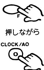
Fスイッチを押しながら(②～③の操作までFスイッチは押し続ける)AOキーを押します。
