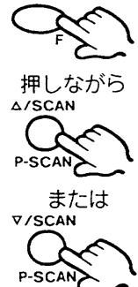
Fスイッチを押しながら△または▽キーを押すと、スキップチャンネルを飛び越えてスキャンします。
