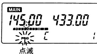
一時停止中は“PRIO”表示が点滅し、信号が途切れると約2秒後、信号が続いているときは約5秒後に再スタート(P49,52)します。
