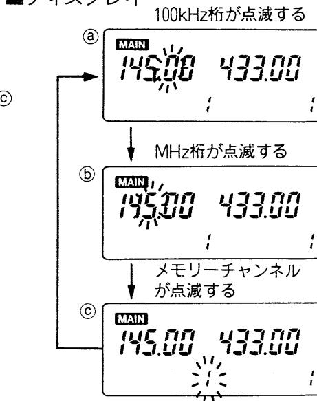
Fスイッチを押しながら(②～③の操作までFスイッチは押し続ける)D SELキーを押すごとに実行桁(点滅している桁)が移動しますので、実行したい桁を選択してください。
