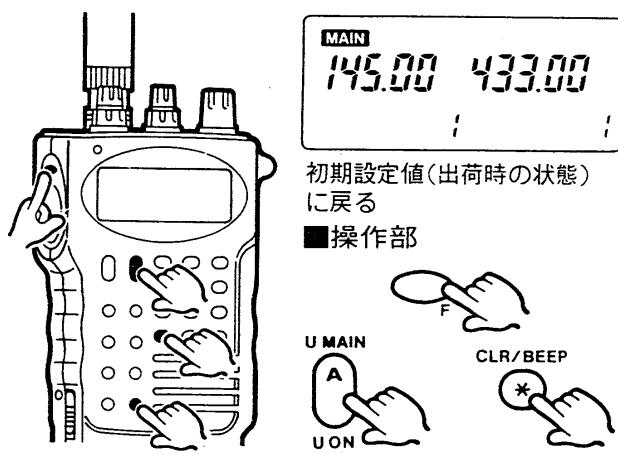
Fスイッチ、Aおよび\*キーを押しながらPOWERキーを約1秒押します。
