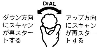
信号が途切れると約2秒後、信号が続いているときは約5秒後に再スタート(P49,52)します。また、DIALを回すと強制的に再スタートします。
